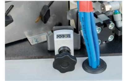
Regulación simultánea de la unidad tupí, la unidad de encolado y la selección del grosor del canto mediante un único contador digital.
