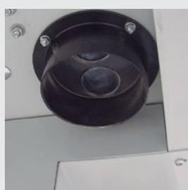
Aspiración centralizada con tomas en toda la línea de trabajo. Dispone de una conexión para 2 tubos de 100 milímetros de diámetro, ideal para sistemas de aspiración externos con un caudal mínimo de 1.000 m<sup>3</sup>/h
