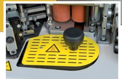
Depósito de cola con tratamiento de polimerización antiadherente. Reducción importante del consumo de cola.
