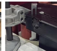
Guide de sortie du chant réglable, garantissant le parallélisme du chant avec le panneau.
