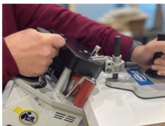
Finition parfaite sur des panneaux droits, ronds, avec des formes et biseautés (jusqu'à 10°).
