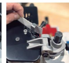
Réglage facile de la hauteur du panneau et de la hauteur de sortie du chant.
