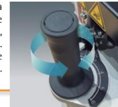
Regulación electrónica de la velocidad de avance incluso durante el trabajo, girando la empuñadura. Hasta 4 velocidades de trabajo disponibles.
