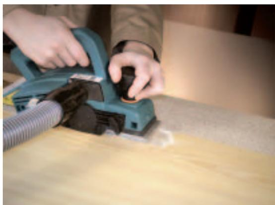
La capacidad de extracción del rodillo lijador que incorporan ambos modelos permite incluso extraer con precisión recubrimientos sintéticos como la melamina, ya sea en la superficie como en el canto.
