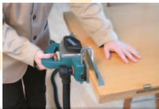
Su utilización hace posible realizar lijados sobre piezas compuestas de varias capas de diferentes materiales, y de diferente dureza y textura, como módulos aislantes, tablas de surf, etc...
