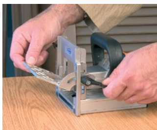
Frontal regulable en ángulo y altura con escalas graduadas.
