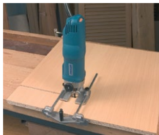
Fresado de regatas paralelas con guía lateral.
