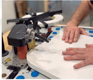
Aplacado de paneles rectos, con formas, o biselados (hasta 45°).
