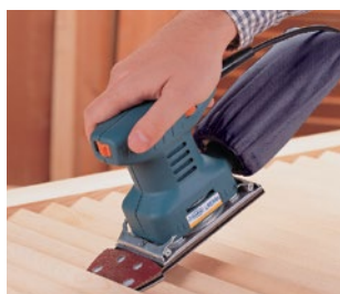
Lijado de superficies de difícil acceso, como persianas de librillo, etc.
