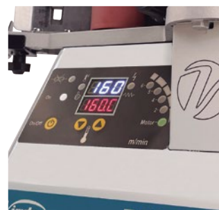
Regulación de la temperatura (120 a 200°C) controlada por microprocesador para una mayor exactitud en la medición.
