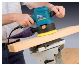
Soporte abatible y giratorio regulable.
