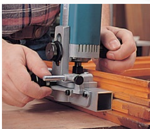
Ranurado de ventana por lado vierte aguas.
