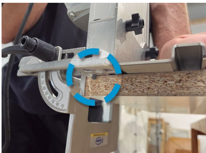
Sistema de posicionamiento automático de topes retráctiles.
