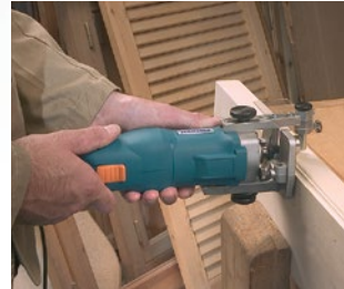
Realización de molduras.
