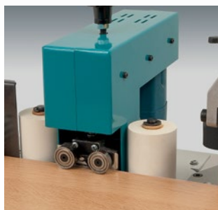
Incluye un perfilador para el perfilado del sobrante en cantos de hasta 1 mm de espesor
