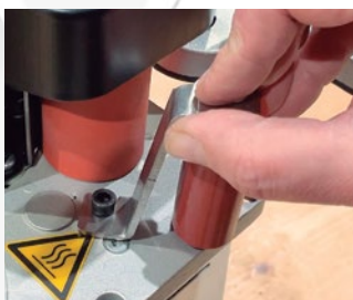
Rodillo auxiliar para aplacados a 90°. Es posible colocarlo en 2 posiciones diferentes según la pieza a cantar.
