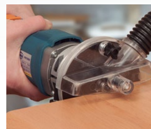
Cabezal redondo V3 para perfilar con apoyo sobre el canto.
