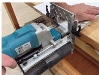
Fácil y rápida perforación en el canto del panel, a 90° y 45°.
