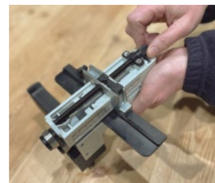
Ajuste micrométrico de la anchura de corte.
