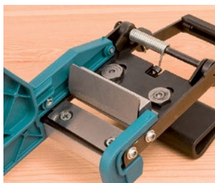
Sistema de corte con dos cuchillas.
