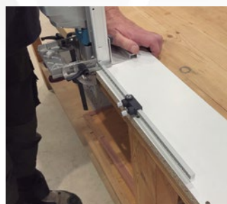
Tope longitudinal ref. 7946705 (incluido) Para la realización de orificios a distancias determinadas. Paso mínimo 5 mm.
