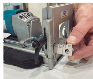
Fácil regulación del grosor del tablero mediante galga incorporada.
