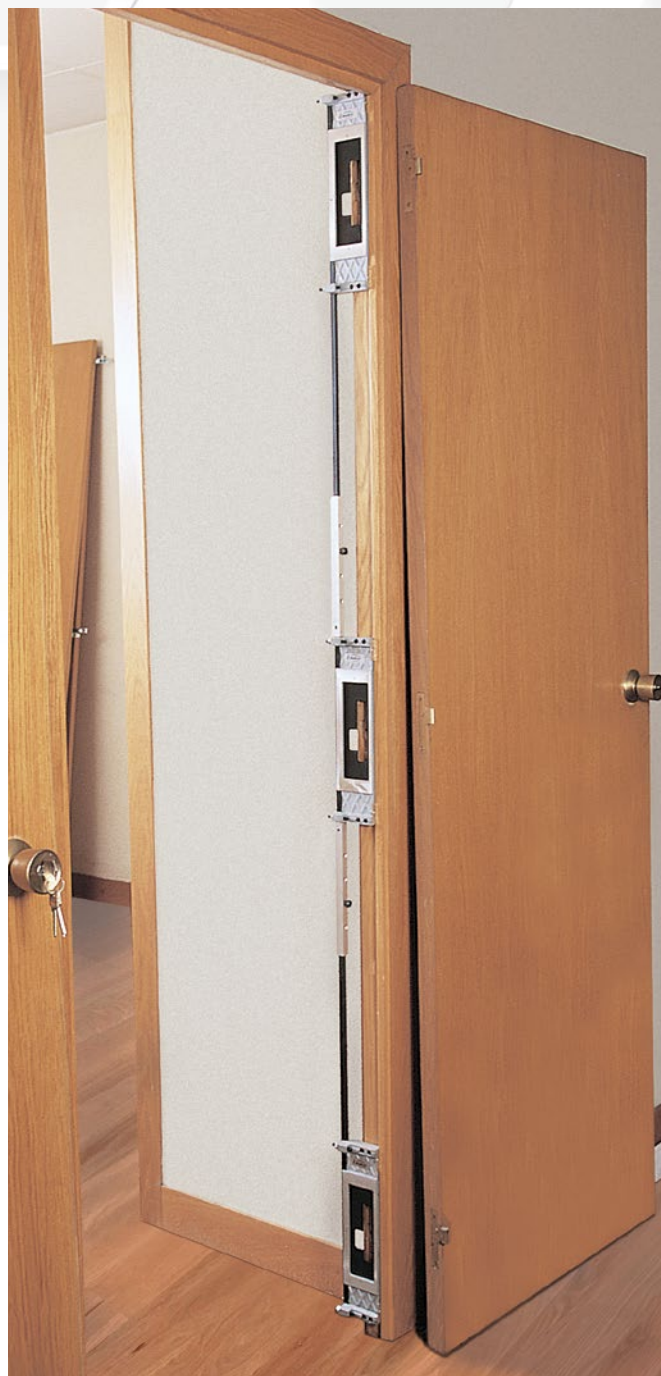
Portapantillas A093 de tres cuerpos.
