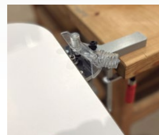
El uso estacionario de la fresadora FR156N usando el SA100 ofrece una gran estabilidad y permite perfilados de precisión con excelentes acabados.
