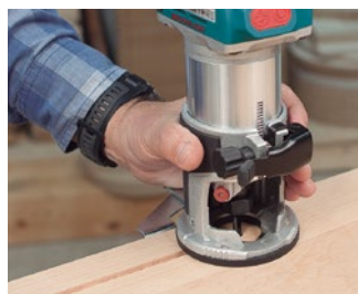
Realización de regatas.
