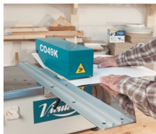
Ajuste fácil de ancho de tira a cortar.
