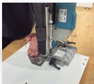
Escuadra ref. 7946699 (incluida) Para el posicionamiento de la máquina sin necesidad de tomar medidas. Ideal para la colocación de baldas intermedias.
