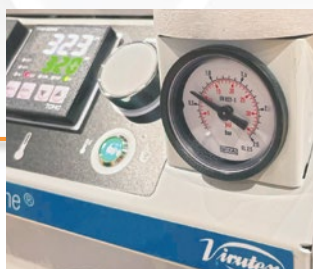
Presión del aire comprimido autorregulada.
