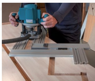
Fácil y rápido fresado y trazado de los encajes en los largueros.
