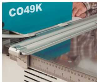
Ajuste fácil de ancho de tira a cortar.
