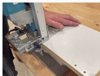
Fácil y rápida perforación en el canto del panel, a 90° y 45°.
