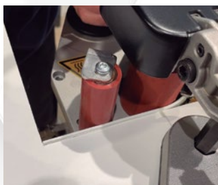
Aplacado de esquinas a 90°.
