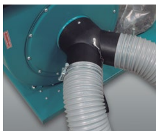
Con dos tomas de aspiración, incluye de origen 2 tubos de Ø 100 mm.
