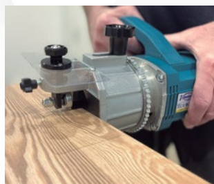
Perfilado de estratificados.
