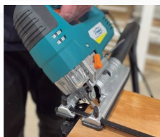
Base inclinable de 0° a 45°.
