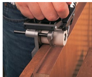
Aplacado de la cara superior del solape.
