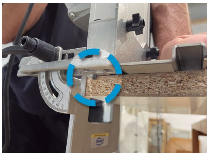
Sistema de posicionamiento automático de topes retráctiles.
