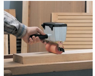
Encolado con colas vinílicas (blancas).
